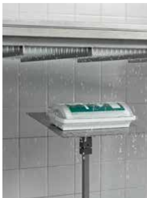
K2 luminaire IP test
